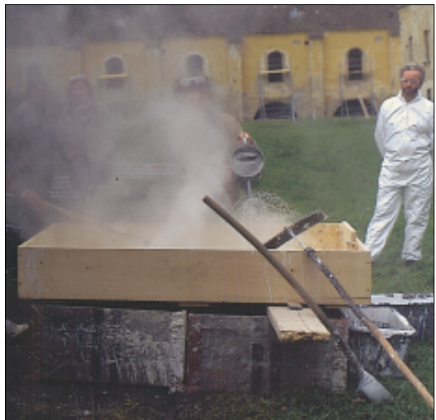
Abb. 2: EU-Projekt „Limeworks“, Löschen des Stückkalkes
